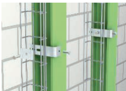
Montage vertical sur un IPN avec la patte de serrage type BFK et la pièce de serrage centrale type GKS.
