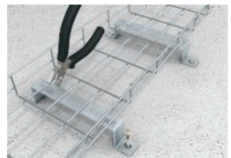
Montage d'un chemin de câble en treillis au sol avec l'étrier de suspension à ergots type DBLG. Fixation sans vis grâce aux ergots.
